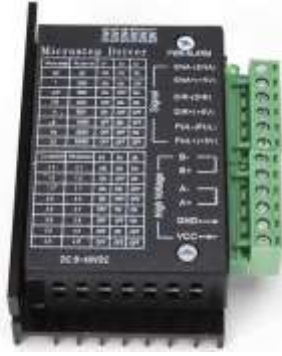
Şekil -6 Step Motor Sürücü Şekil-7 PLC ve Step Motor Sürücü Bağlantısı
