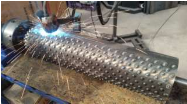
Şekil 3. Mikrodenetleyici kontrollü gaz altı kaynak makinası ve kontrol panosu
