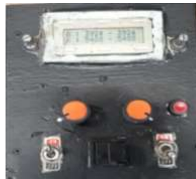
Şekil 3. Mikrodenetleyici kontrollü gaz altı kaynak makinası ve kontrol panosu
